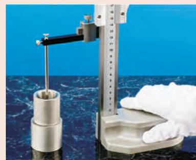
Accessoire pour la mesure de profondeur
